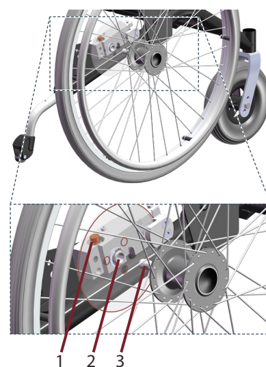
Figur 6. Borttagning av hjul
