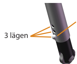
Figur 8. Tippskyddets 3 lägen som ställs in med snäpplås
