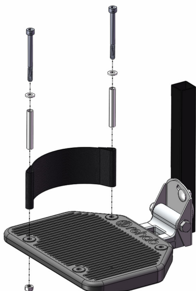
Figur 1. Montera ihop skruvar, brickor, rör, hälband, fotplatta och muttrar enligt figuren. Använd en insexnyckel (5 mm). Skruva åt ordentligt.
