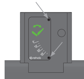
Figur 11. 87214, monteras med de svarta punkterna mitt för hålen i plåtlådan.
