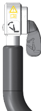
Figur 7. Märkning av rullstol med utökad ryggfällning.
