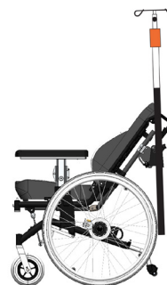
Figur 10. Ryggfälld rullstol där fästet roterats för att droppställningen ska hållas vertikalt.
