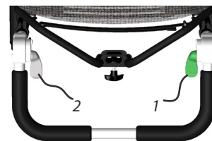
Figur 14. Reglage för sitstilt (1) och ryggfällning (2).
